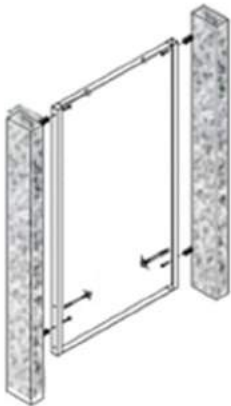
Montage zwischen Steinsäulen
