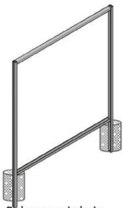
Rahmen wird einbetoniert (Standard)
